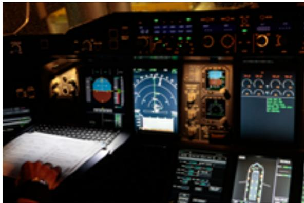
Près d'une quinzaine de systèmes et d'équipements signés Thales équipent l'A 380, aussi bien dans le cockpit (système de visualisation, avionique modulaire intégrée, etc.) qu'en cabine (multimédia de bord).
